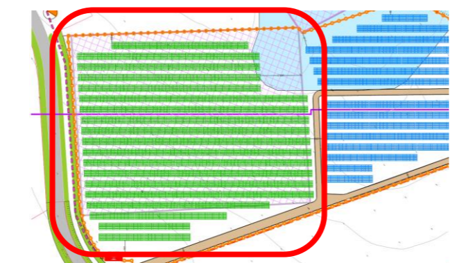
Implantation des modules selon la technique des longrines (en vert)
